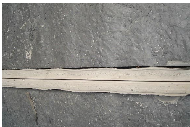
Figura 04. Rocha já preparada para ser comercializada, onde são visíveis as camadas (varves). Localização: município de Trombudo Central/SC. Foto: Juliana Loch, 2010.
