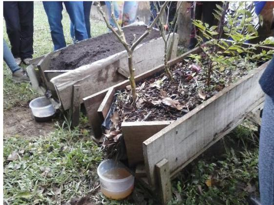
**Figura 6** – Simulações de deslizamentos para ensinar a importância de se ter áreas de encostas vegetadas.
